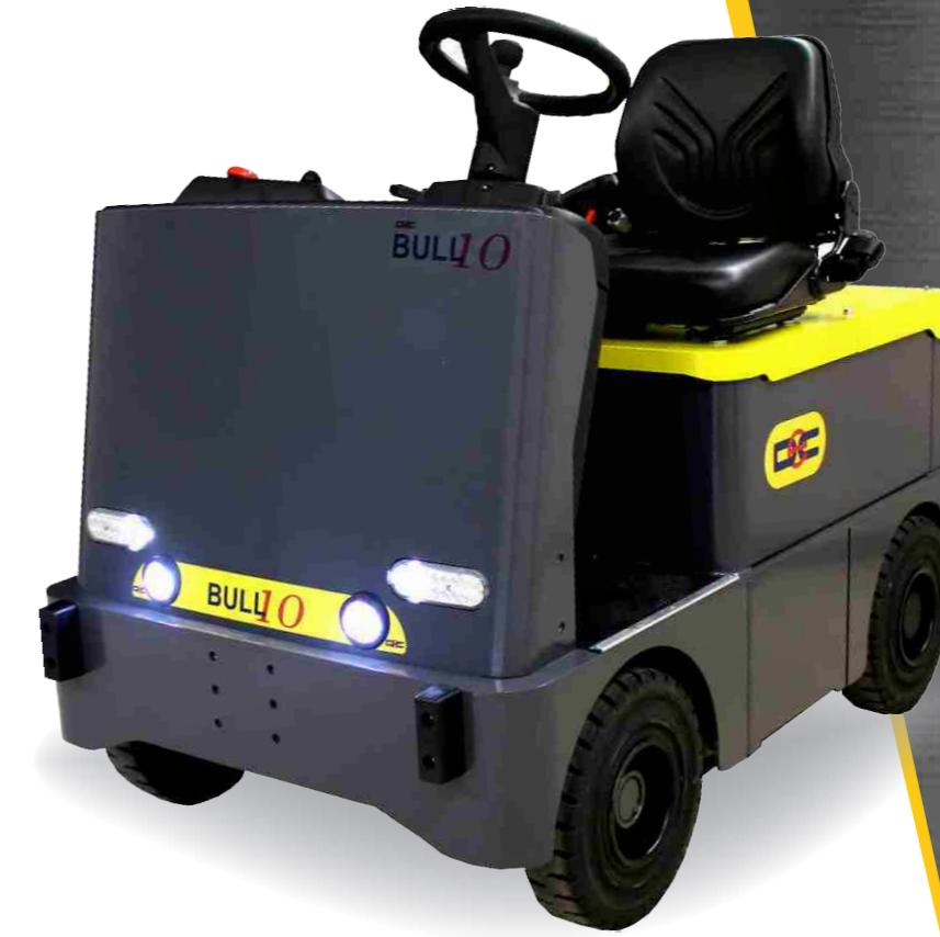
Il lamiera d'acciaio saldata elettricamente ad arco, forma una struttura portante rigida. La particolare conformazione permette una ottima accessibilità ai componenti. Il ponte anteriore, ammortizzato, è costituito da uno scatolato in lamiera con mozzi, boccole, perni di notevoli dimensioni e precisioni.
