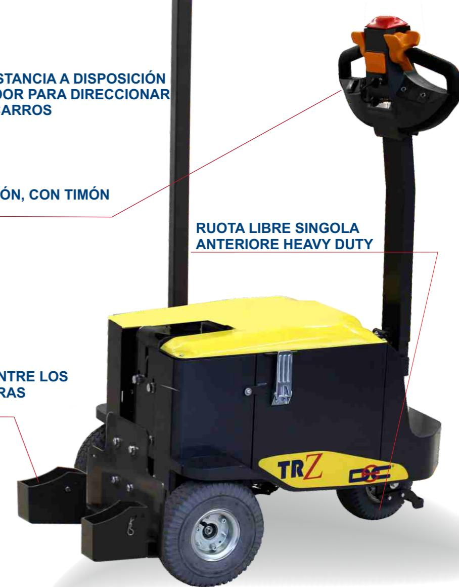
Los tractores de arrastre TR Z Lift y TR Z Lift br son máquinas diseñadas para mover remolques sin timón ni enganche de tracción dentro de las plantas.
